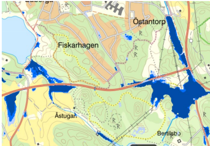
Figur 2. Lågpunktskartering över del av väg 134 samt korsningen väg 134/riksväg 35
