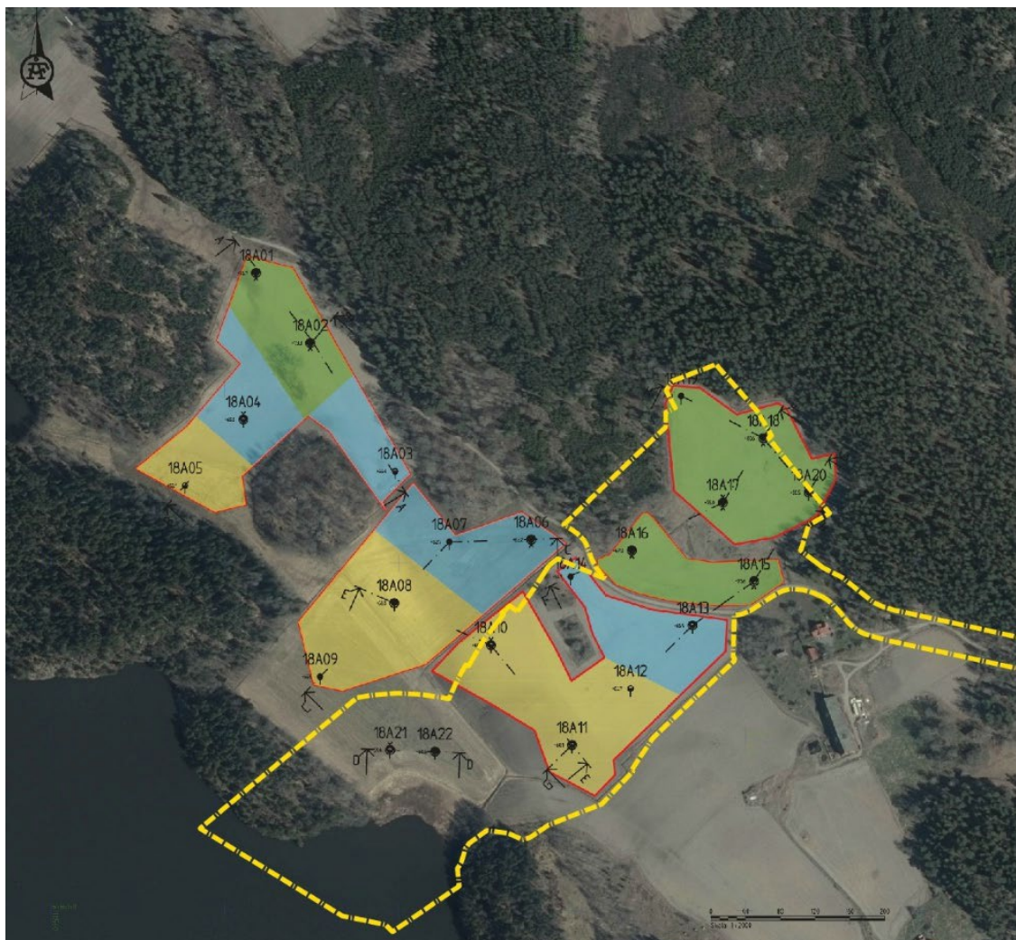
Figur 12. Från geoteknisk undersökning (ÅF Infrastructure, 2018), gulstreckad linje visar planområdesgräns för detaljplan etapp 1. Gult delområde – byggnader kan behöva grundläggas med spetsburna pålar. Blått delområde - där envåningshus överlag bedöms kunna grundläggas med platta/plattor på/i mark men där flervåningshus överlag kan behöva grundläggas med spetsburna pålar. Grönt delområde- byggnader bedöms kunna grundläggas med platta/plattor på/ i mark alternativt med plintar på fast botten.
