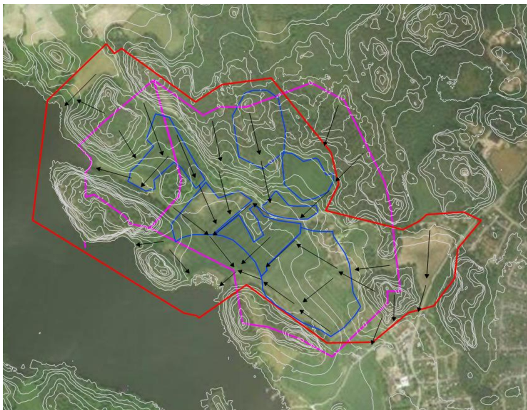
Figur 15. Rödmarkering illustrerar planprogramområdesgräns samt de blåmarkerade områdena visar vart bostadsbebyggelsen är tänkt att placeras. Lilamarkering visar ungefärliga avrinningsområden för ytlig avrinning idag (år 2018). Svarta pilar visar övergripande flödesriktning.
