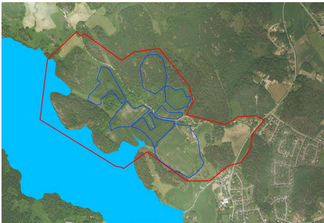
Figur 5. Det blå området illustrerar det område som sätts under vatten vid ett 100-årsflöde, dvs en översvämning som statistiskt inträffar 1 gång på 100 år (MSB Portal för översvämningshot, 2018). Rödmarkering illustrerar planprogramområdesgräns samt de blåmarkerade områdena visar vart bostadsbebyggelsen är tänkt att placeras.
